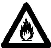
Matières inflammables ou haute température (1)
